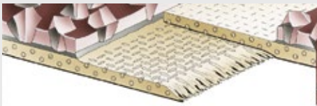
Joint à recouvrement avec enlèvement de grains
