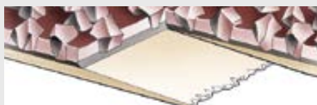
Joint à recouvrement sans enlèvement de grains
