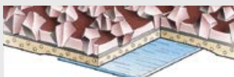
Joint bord à bord avec film de renfort au dos
