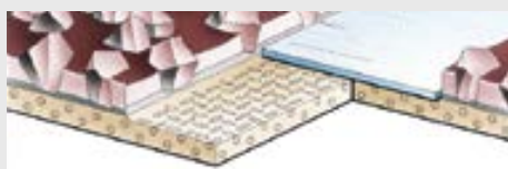
Joint bord à bord avec film de renfort côté grains
