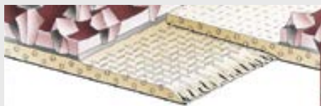
Joint à recouvrement avec enlèvement de grains
