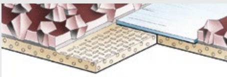
Unión a presión con lámina especial en el lado del grano
