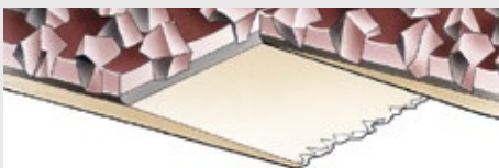
Unión solapada sin lijado de grano
