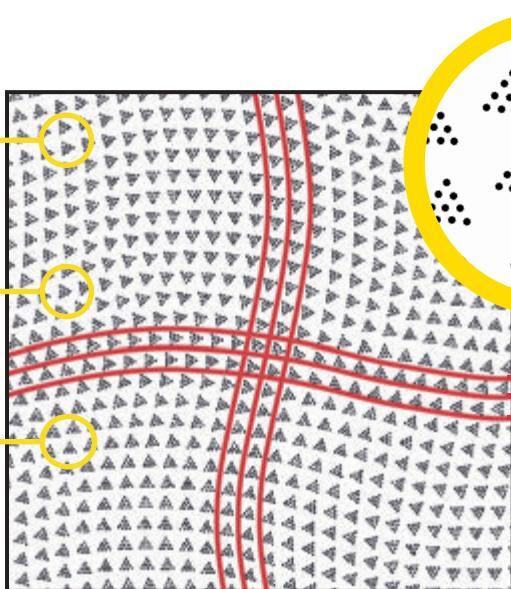
Disposição senoidal das curvas para uma remoção ideal do pó
