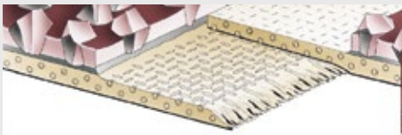
Overlappende las met korrelafslijping
