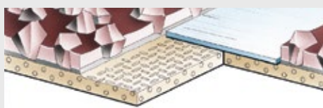
Typ 4: Gestossene Verbindung mit kornseitiger Spezialfolie
