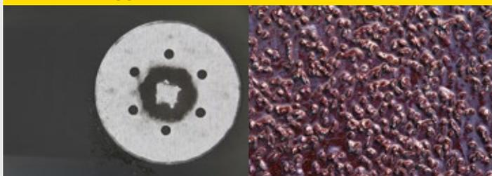
La grana abrasiva su un supporto in tela o in carta viene ricoperta dal secondo strato di legante e l'aspirazione della polvere avviene quasi esclusivamente attraverso i fori. La cospersione elettrostatica della grana, infatti, non crea spazi sufficienti in cui la polvere possa depositarsi e ciò influisce fortemente sulla durata utile dell'abrasivo.
