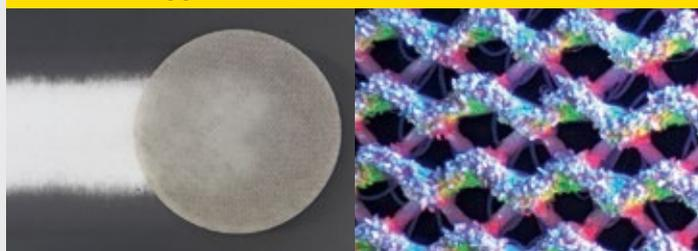
Un apposito supporto a rete, composto da una fibra di poliestere, viene cosparsa mediante una moderna tecnica di produzione specifica. Grazie ad un raffinato processo, la grana viene applicata solo sulla parte superiore del supporto a rete. La struttura funzionale interna e il lato posteriore dell'abrasivo, dotato dei ganci di ancoraggio siafast, restano invece privi di grana abrasiva.
