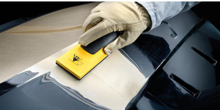
Ein kompatibles, geschlossenes System bestehend aus Feilen, Blöcken mit Absaugschlauch und Verbindungselementen steht Ihnen zur Auswahl. Das komplette Sortiment der Handsleifgeräte zeichnet sich durch ein geringes Gewicht in Kombination mit ergonomisch geformten Griffen für angenehmes Schleifen aus. Eine direkte und gleichmässige Kraftübertragung auf das Werkstück ist stets sichergestellt.
